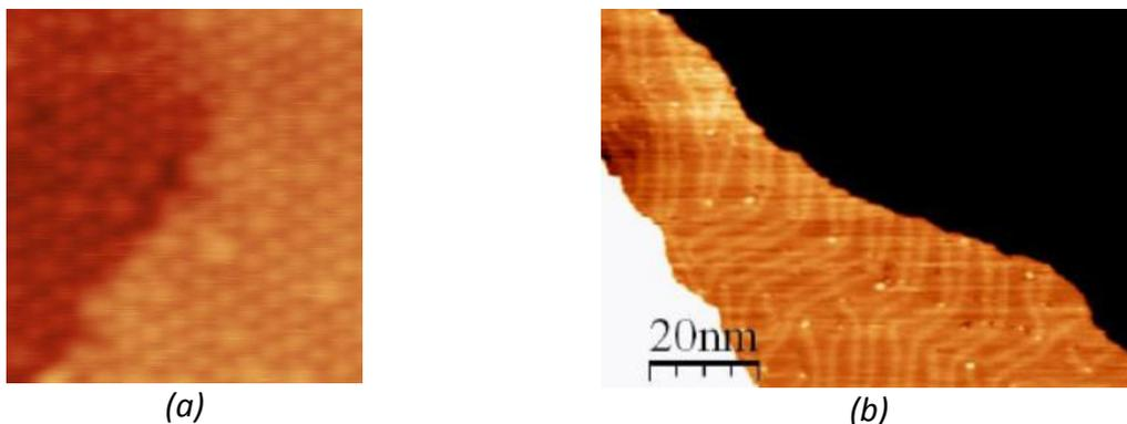
*Observations STM de matériaux cristallins sous contrainte à l'échelle atomique (a) Marche élémentaire en surface d'un monocristal de niobium déformé à température ambiante (b) Reconstruction en chevrons d'un monocristal d'or(111) sous une contrainte de 4 MPa.*
